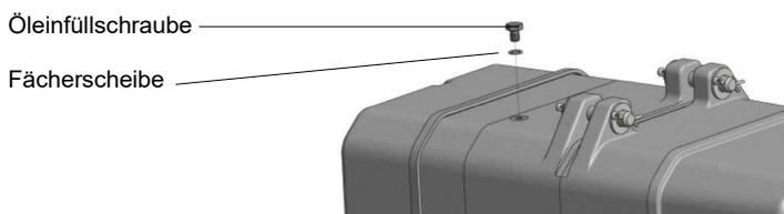
Bild 9: Öleinfüllschraube
