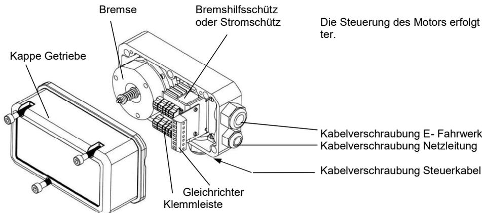
Die Steuerung des Motors erfolgt direkt über den Steuerschalter.
