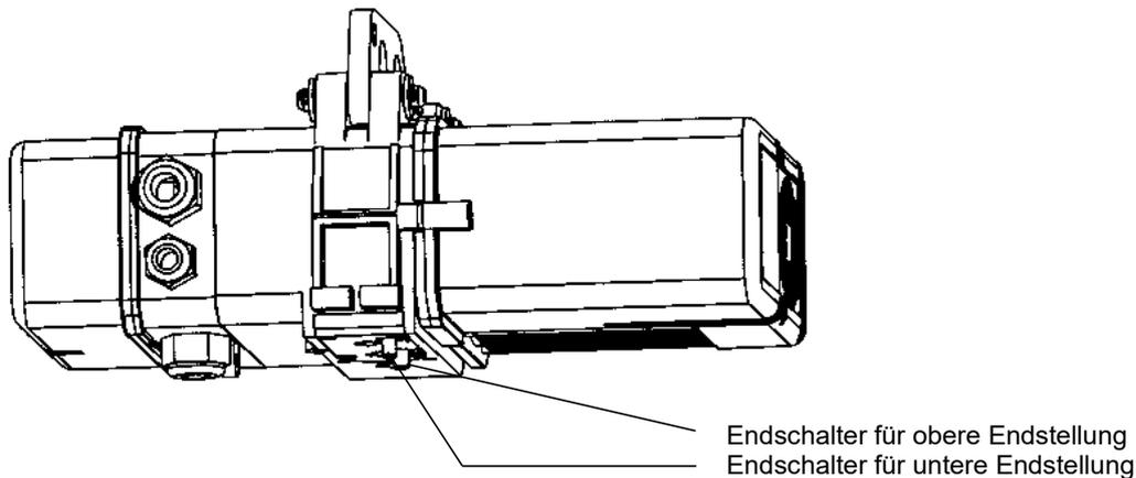
Bild 19: Zusätzliche elektrische Endschalter bei Schützsteuerung
