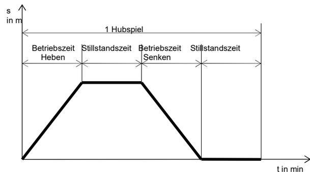
Die Einschaltdauer wird begrenzt durch die zulässige Erwärmung des Hubmotors. Die Betriebszeit ist abhängig von der erforderlichen Hubhöhe, der Hubgeschwindigkeit des Elektrokettenzuges und der Anzahl der Hubbewegungen für einen bestimmten Transportprozess (Entladung von Lastwagen, Beschickung von Maschinen).
