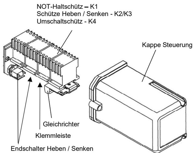
Bild 18: Schützsteuerung
